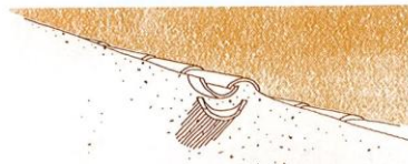
Gargouilles en tuile canal sur rive braise.
