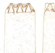
Tuiles creuses en biais, calage maçonnerie
